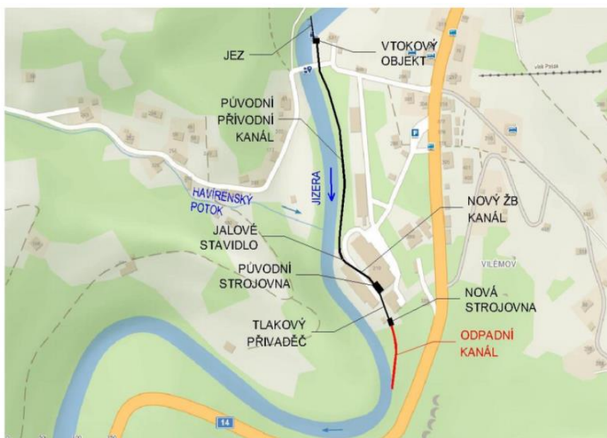
Obr. 10- Situační uspořádání MVE Vilémov, [11]
